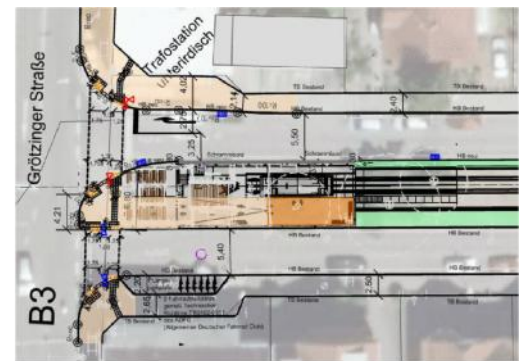
Abb. 18: Einmündungsbereich B3 mit Fußgängerfurt
